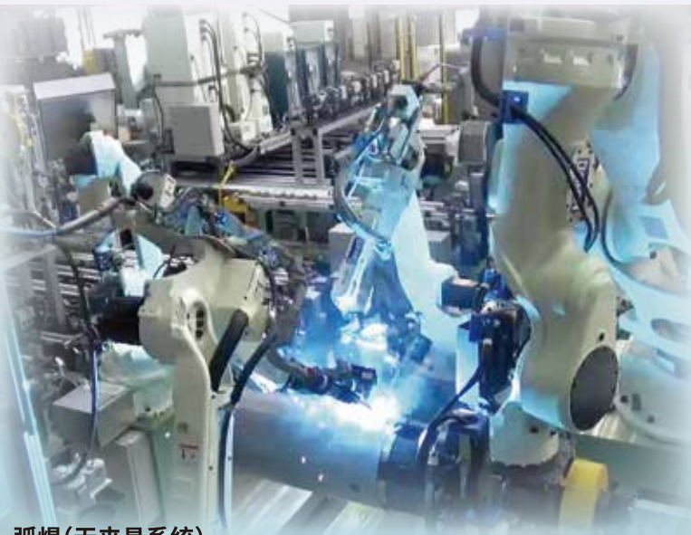
弧焊(无夹具系统)
